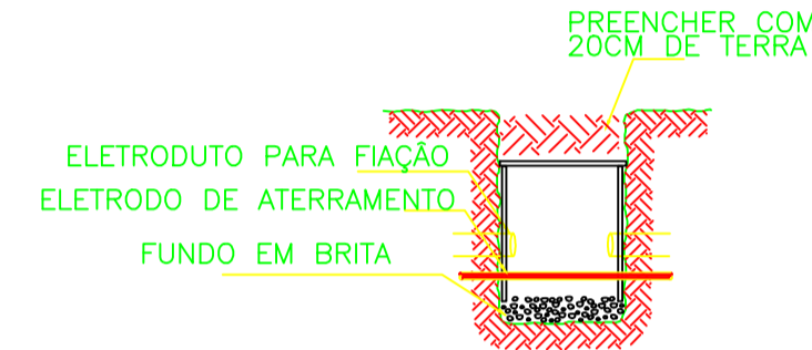
Detalhe da caixa de passagem com eletrodutos, aterramento, e lampa em concreto enterrada.
