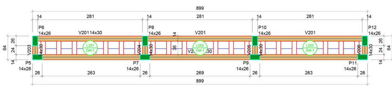
FORMA DO PAVIMENTO DEGRAU 02 (NÍVEL 100) escala 1:50
